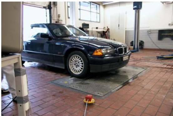
Bild 5.1 Fahrzeugprüfstand in Betrieb. Diese Anlage wurde als Referenzanlage verwendet.
