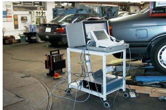
Bild 5.2 Messungen mit dyn. Erreger am Standort des projektierten Prüfstandes
